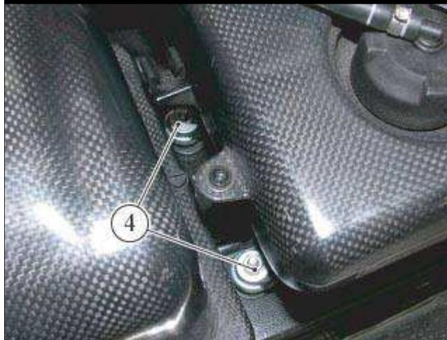
■ 将膨胀水箱安装在其相应底座中并通过拧紧两个螺母(4)固定。
