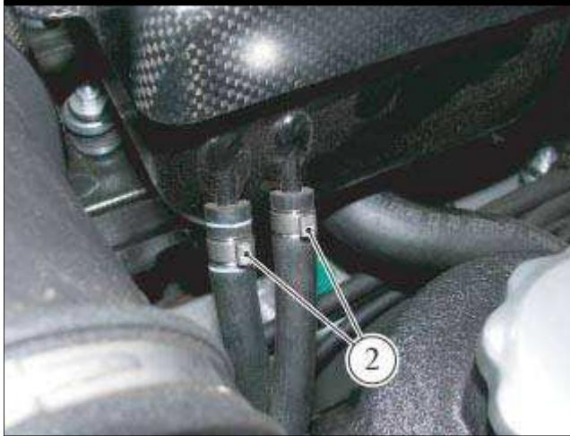
● 打开两个夹子**(2)**, 然后从储液罐断开管。
