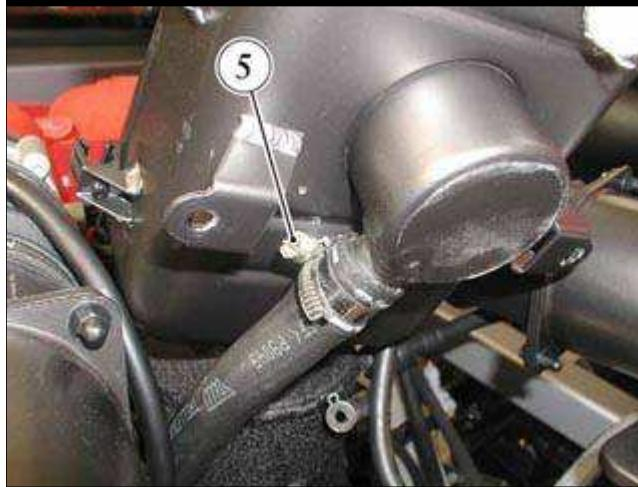
■ 将系统输送管连接到膨胀水箱上并通过拧紧夹子(5)紧固。
