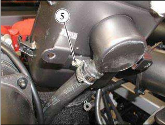
● 打开夹子**(5)**并断开系统输送管。
