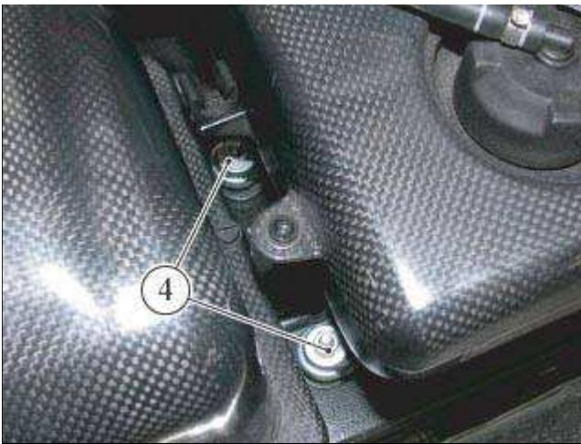
● 松开固定膨胀水箱的两个螺母**(4)**。
