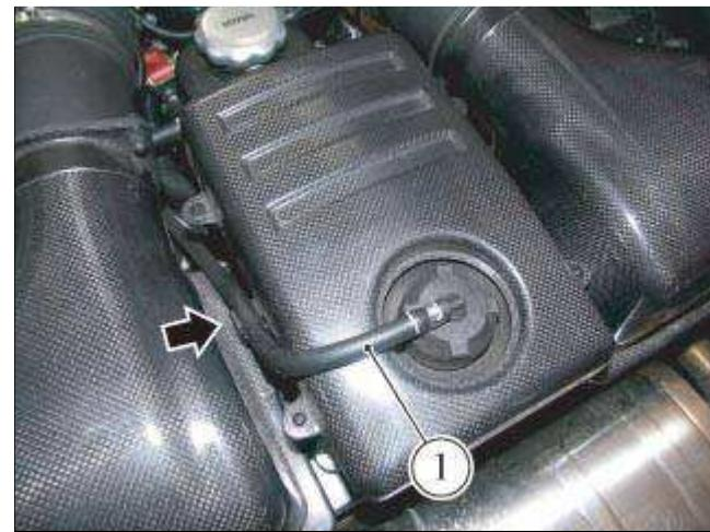
● 将通气管(1)连接至盖并使用固定夹紧固。
