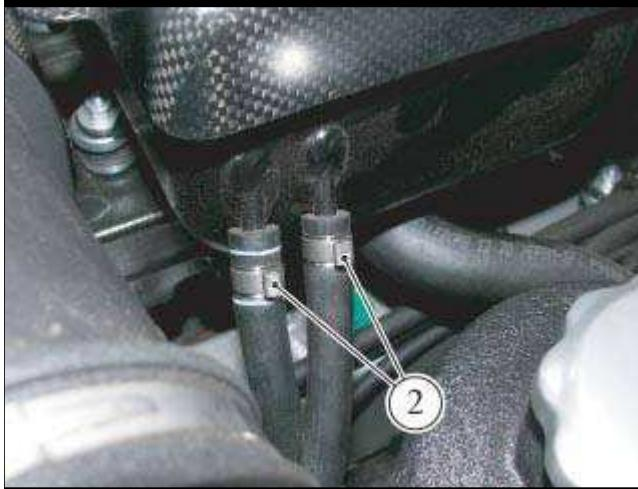
■ 将管连接至储液罐并通过拧紧两个夹子**(2)**紧固。
