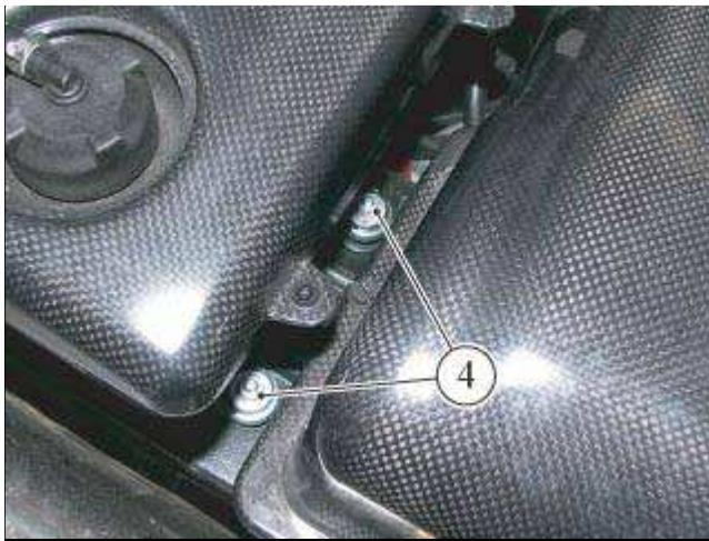
■ 拧紧固定膨胀水箱的两个螺母**(4)**。
